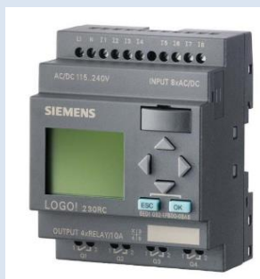
Fig. 2 Automat programabil Siemens, aspect fizic
